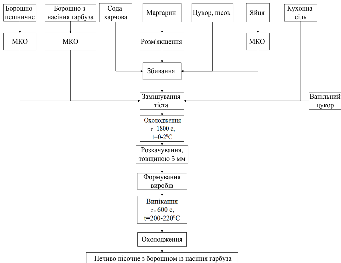
Рис. 1. Технологічна схема приготування пісочного печива з борошном із насіння гарбуза
