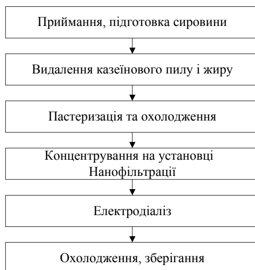
Рис. 1. Основні технологічні операції виробництва демінералізованої суміші із сироватки
